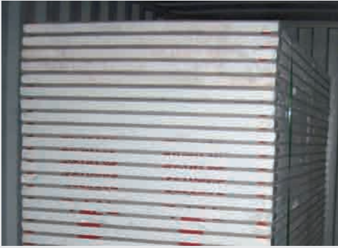
Resim 46 Prefabrik Bina Duvar Panelleri
